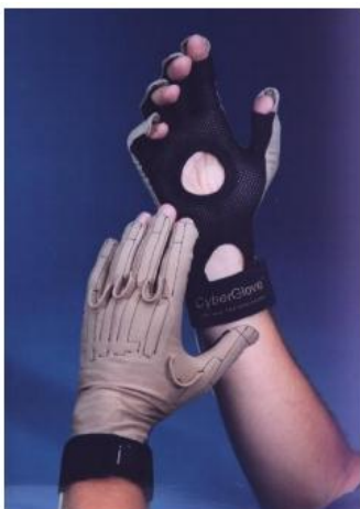
The CyberGlove Handschuh mit 22 Sensoren
